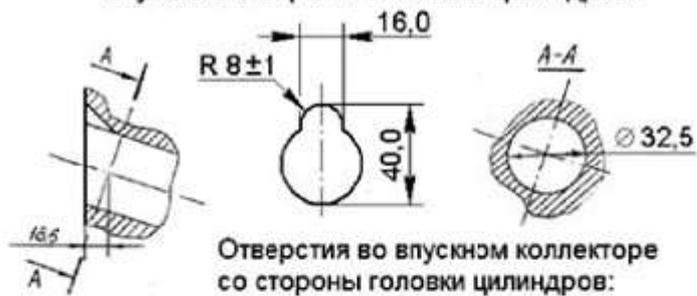
Отверстия во впускном коллекторе со стороны головки цилиндров:
